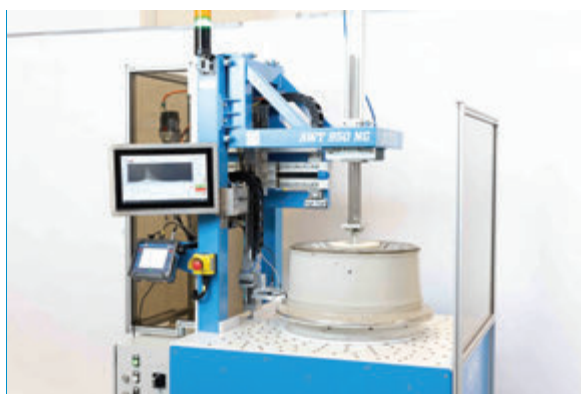
ET – AWT 950NG (LETECKÁ ÚDRŽBA) – ZKOUŠENÍ KOL
